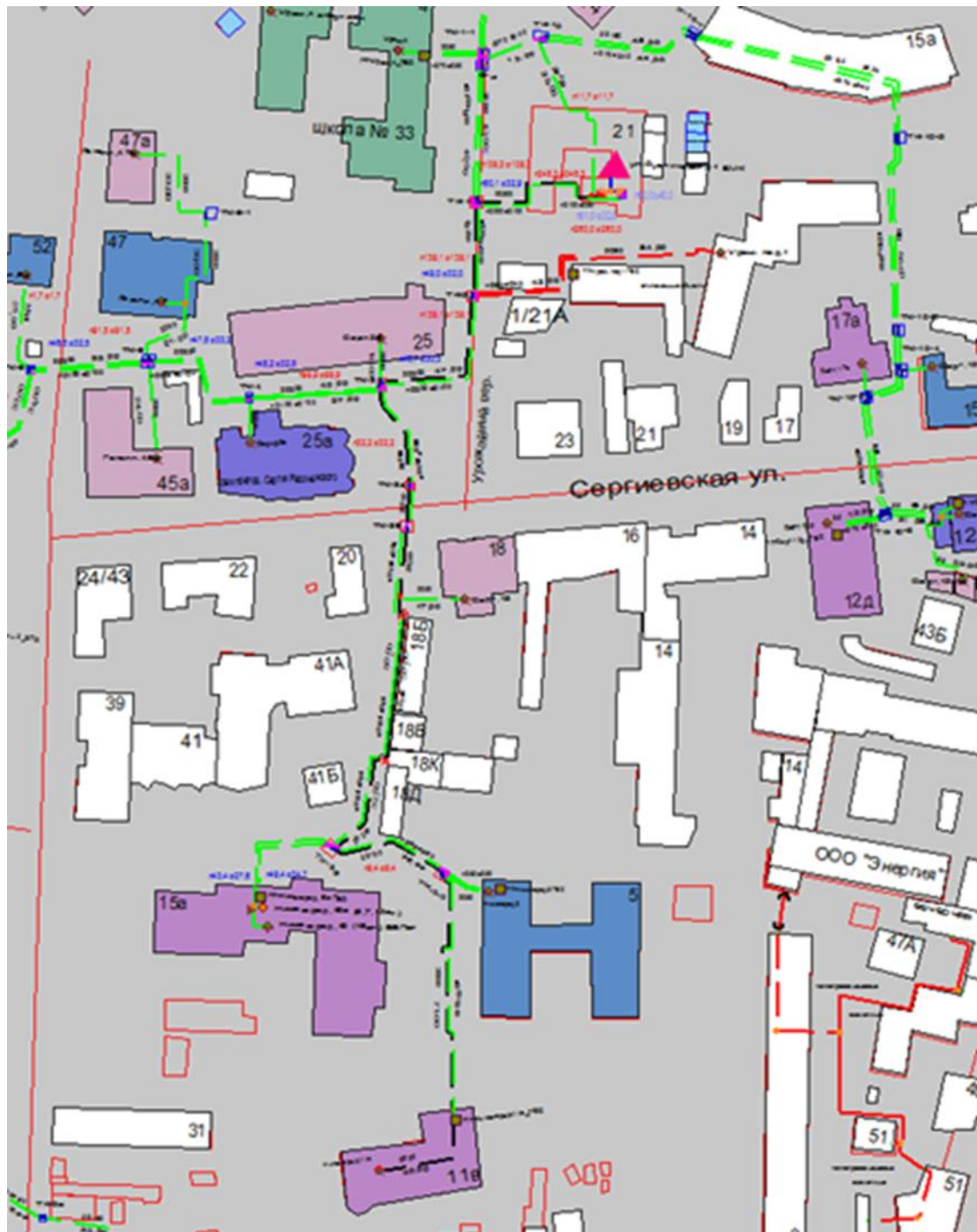
Рисунок 3.21 – Трассировка теплопровода от котельной АО «Теплоэнерго» по ул. Суетинская, д. 21 (БМК) до конечного потребителя «ПТ-Нижегород,11в»
