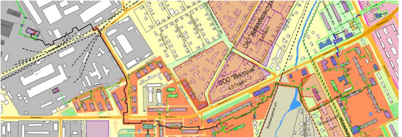
Рисунок 3.153 – Трассировка теплопровода от котельной ФГУП «Завод Электромаш» по ул. Федосеенко, д. 64 до конечного потребителя «ПТ-Остров,9»
