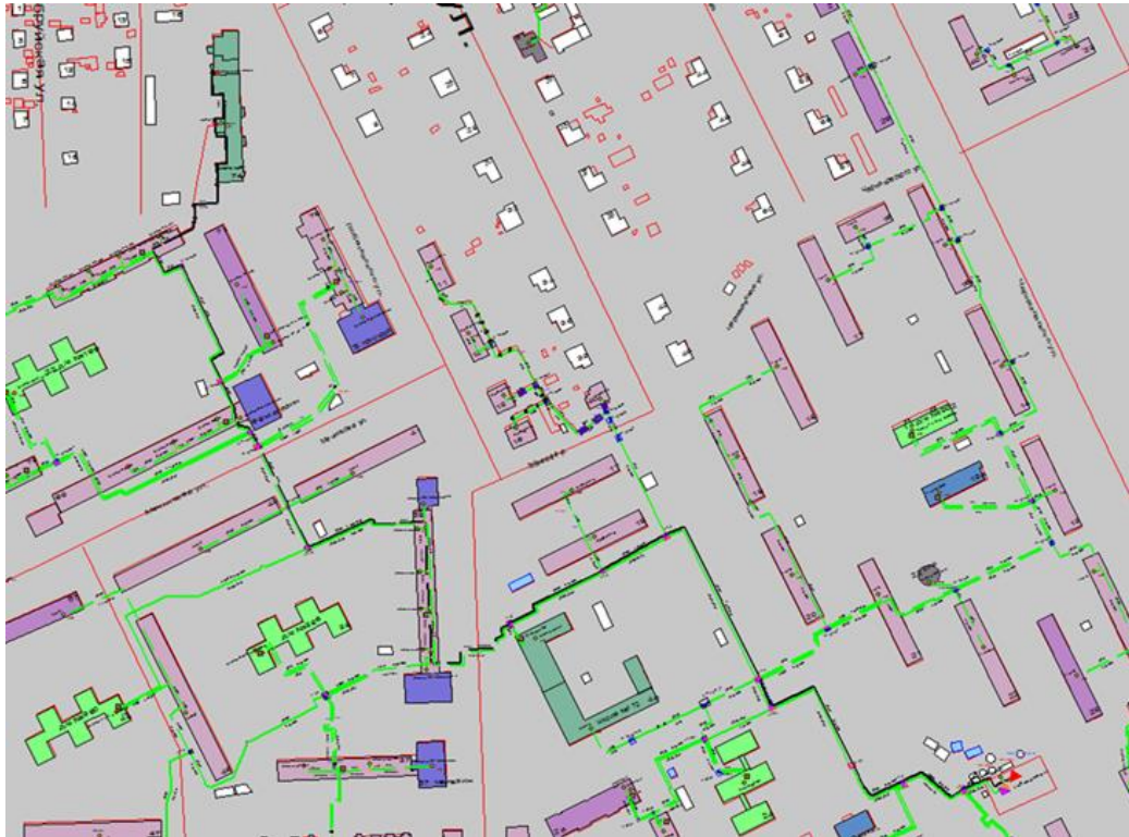
Рисунок 3.37 – Трассировка теплопровода от котельной АО «Теплоэнерго» по ул. Баранова, д. 11 до конечного потребителя «ПТ-Мечн,74 маст»
