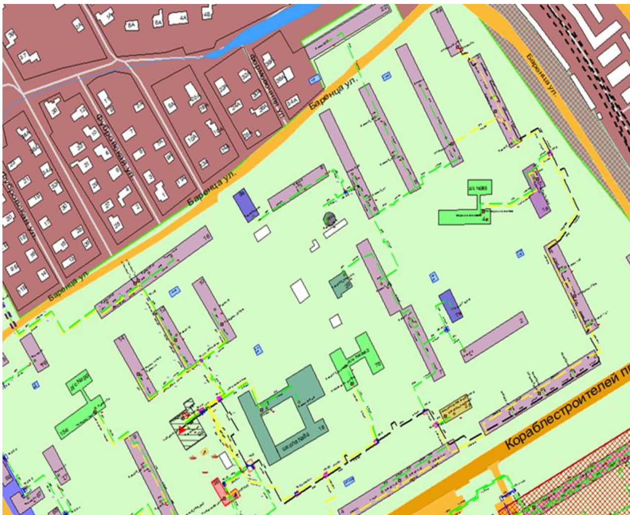
Рисунок 3.121 – Трассировка теплопровода от котельной АО «Теплоэнерго» по ул. Баренца, д. 9А до конечного потребителя «ПТ-Барен,3а»
