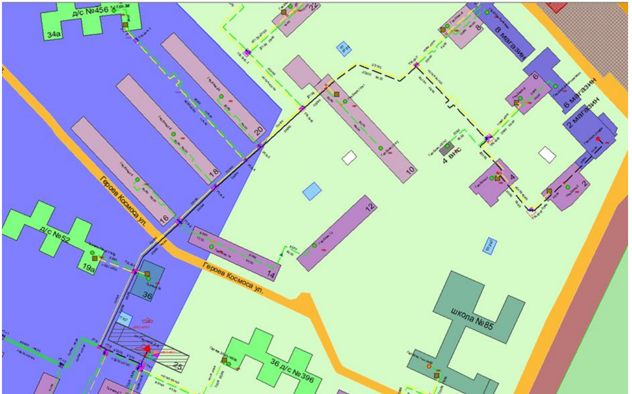
Рисунок 3.61 – Трассировка теплопровода от котельной АО «Теплоэнерго» «7 МР Сормово №2» по ул. Гаугеля, д. 25 до конечного потребителя «ПТ-Гер.Косм,2 кафе»
