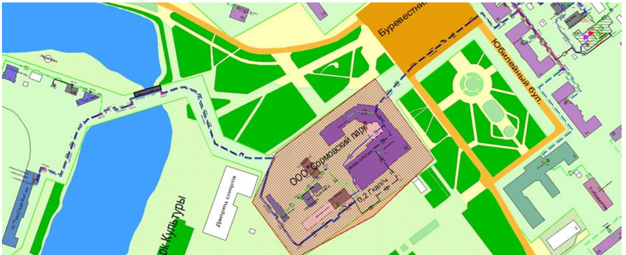
Рисунок 3.89 – Трассировка теплопровода от котельной АО «Теплоэнерго» по ул. Энгельса, д. 1В до конечного потребителя «ПТ-Юбилейн.б-р "Труд"АБК»
