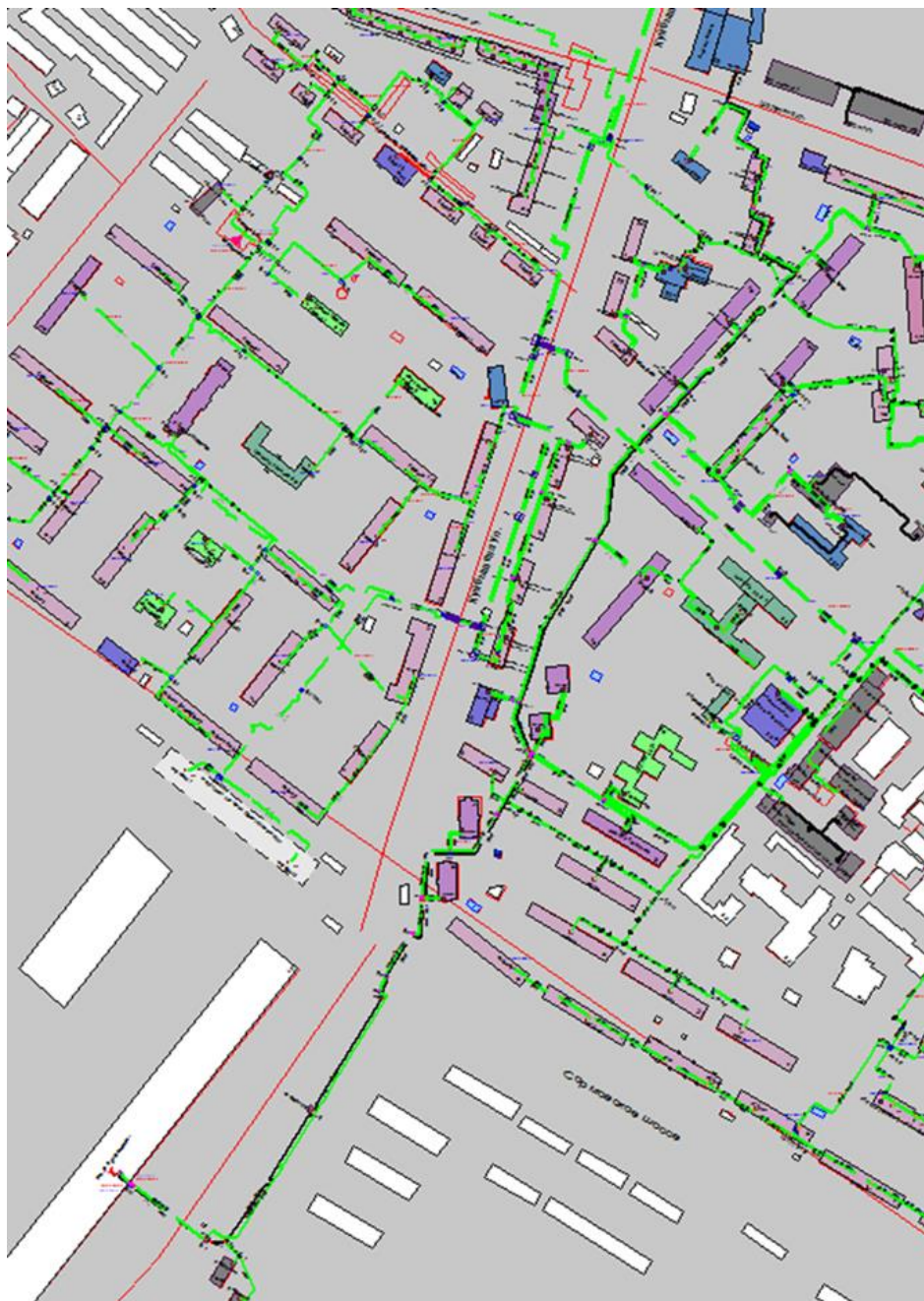
Рисунок 3.157 – Трассировка теплопровода от котельной ГП «ОКБМ им. И.И. Африкантова» по Бурнаковскому пр., д. 15 до конечного потребителя «ПТ-Куйбыш,32,30»
